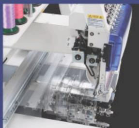
Der Wechsel von Freiarmrahmen auf Kappenrahmen ist schnell und einfach. Die einfach zu bedienende Kappenstickerichtung minimiert die Stillstandszeiten und erhöht die Reaktionszeit für kundenspezifische Wünsche
