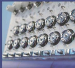
Rotierende Fadenbruchsensoren erkennen präzise jeden Ober- und Unterfadenbruch, halten die Stickmaschine automatisch an und geben dem Anwender ein akustisches Signal.
