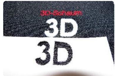
4. Nach Beendigung der Stickerei 3D-Schaum einfach entfernen. (Bei überstehenden Schaumstoffresten, kurz mit dem Feuerzeug entlangfahren und Ränder verschmelzen)
