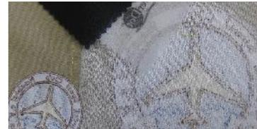
HydroLace ist wasserlöslich und kommt u.a. bei Lace-Stickereien zum Einsatz. Statt des Untergrundmaterials wird diese Folie in den Rahmen gespannt und direkt darauf gestickt. Nach dem Waschen ist nur noch die blanke Stickerei sichtbar. Der Stick ist dann so stabil, dass man ihn beispielsweise als Fensterbild frei aufhängen kann.
