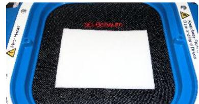
3. Nach Beendigung der Stickfolge die Maschine stoppen (Stopp-Befehl in der Maschine einschalten), 3D-Schaum entfernen und weiter sticken.
