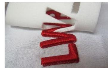
Thermofolie ist eine Klebebeschichtung um Aufnäher aufbügeln zu machen. Ein Aufnähen des Emblems ist dann nicht mehr erforderlich. Die Folie wird direkt nach der Produktion auf die Rückseite, der noch nicht ausgeschnittenen Abzeichen, angebracht.
