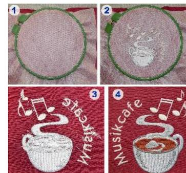
3D-Schaum besteht aus EVA-Schaum und wird für 3D-Stickereien verwendet. Der 3D-Schaum wird mittels eines Sprühklebers am Material befestigt und bestickt. Anschließend wird der überschüssige Schaum per Hand herausgelöst. Harter 3D-Schaum eignet sich für Caps und Embleme, weicher 3D-Schaum für Oberbekleidung.
